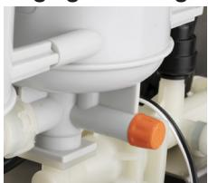
La pompe est dotée d'un système de dérivation pour le réglage du résidu sec de l'eau produite, en phase d'essai la dérivation est complètement serrée. Après l'installation et en phase d'entretien, il faut contrôler et, si nécessaire, régler la dérivation.
