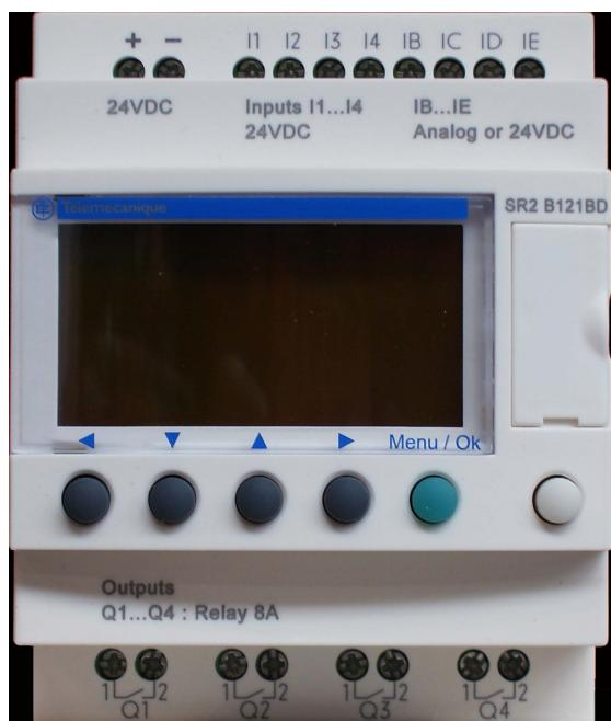
Pour changer le point d'alarme de l'osmoseur appuyez sur la touche **◀** ou **▼**. Sur le display vous verrez le niveau d'alarme installer et la temporisation sur cette alarme.
