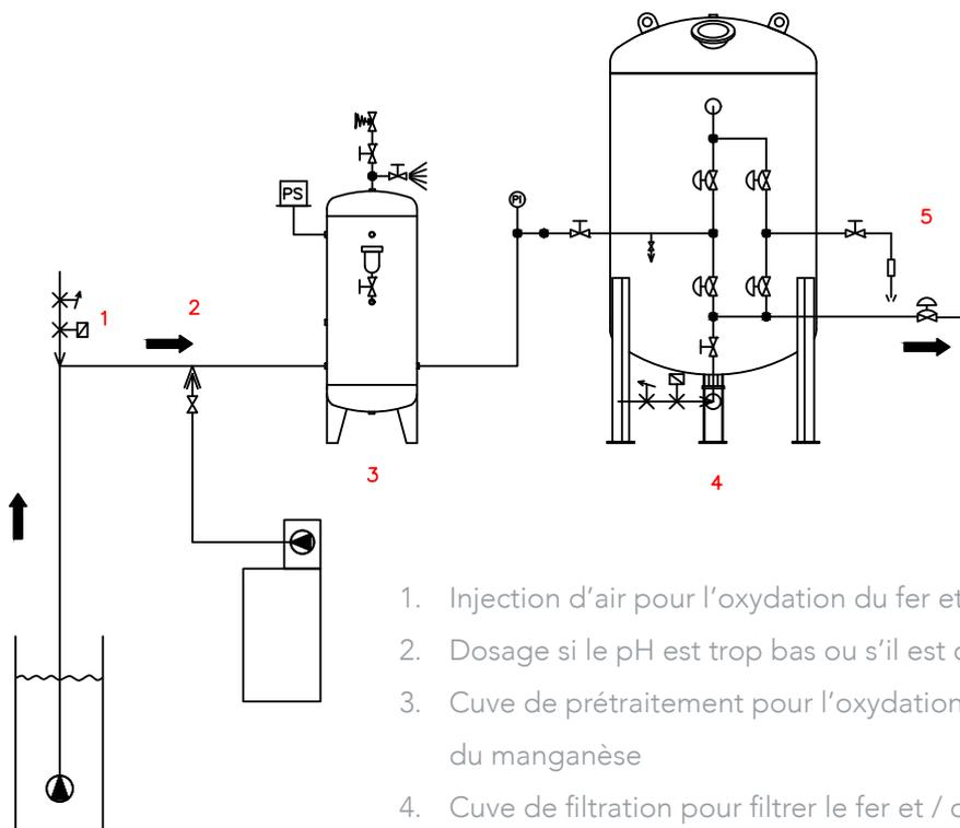
1. Injection d'air pour l'oxydation du fer et / ou du manganèse
